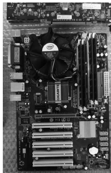
写真.3 取り外したマザーボード
