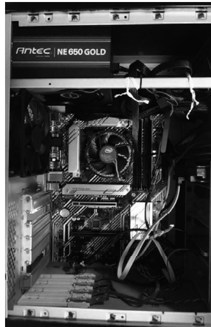
写真. 11 組み立て終了後の内部
