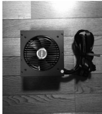
写真. 5 電源ユニット
