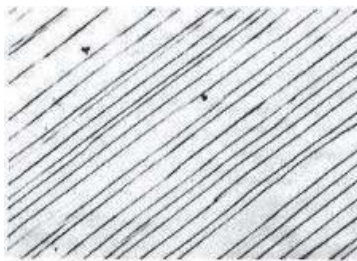
写真 3-1. アルミニウム単結晶の 沁り線(猪子) (×180) 出典: 機械材料の基礎(美馬、長谷川)
